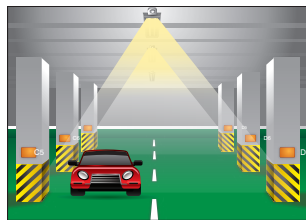
人員/車輛進出時， 照明提升到高亮度的在場 調光
